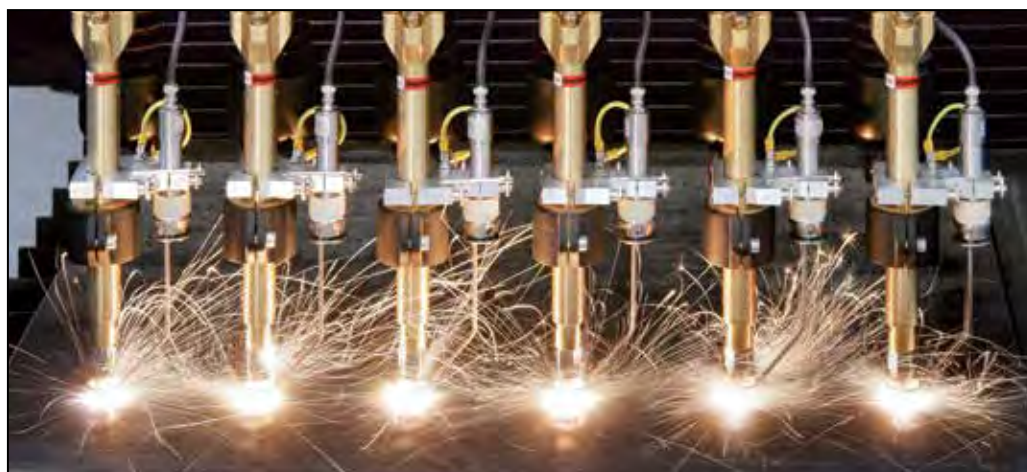
BIR+™ multi-palnik do przebijania otworów
